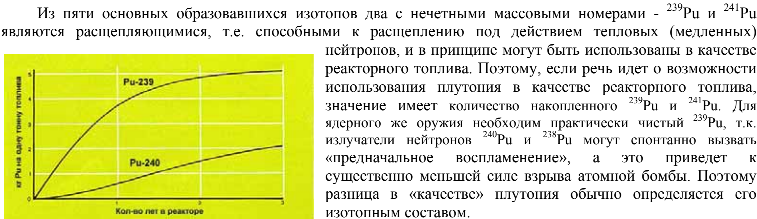
Рис. 16. Накопление изотопов плутония в реакторе
